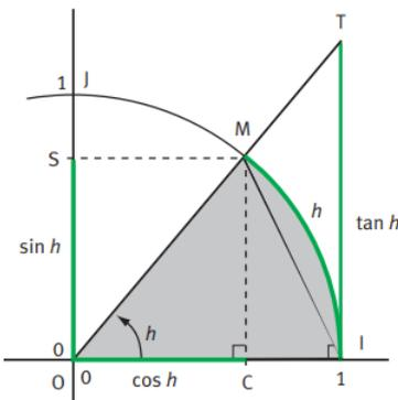
Sur la figure ci-contre, on appelle  $t$  l'aire du triangle OIM ( $\frac{\sin h}{2}$ ),  $T$  l'aire du triangle OIT ( $\frac{\tan h}{2}$ ),  $C$  l'aire du secteur circulaire OIM ( $\frac{h}{2}$ ).
