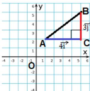
En effet , si un vecteur par exemple  $\vec{AB}$  a pour coordonnées  $(4,3)$ , cela signifie que  $\vec{AB} = \vec{AC} + \vec{CB}$  avec  $\vec{AC} = 4\vec{i}$  et  $\vec{CB} = 3\vec{j}$  et donc  $AC=4$ ,  $CB=3$  et  $(AC)\perp (CB)$  En d'autres termes AB est la diagonale d'un triangle rectangle ACB dont les côtés de l'angle droit mesurent  $AC = 4$  et  $CB = 3$  .
